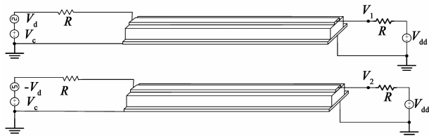
图3 收发机的简单等效电路
